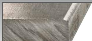
Radio perfecto para la preparación óptima antes de recubrimientos de polvo o pintura de bordes visibles
