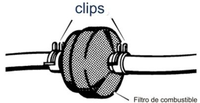
Vacía el tanque de combustible desconectando el tubo. situado en la entrada del filtro de combustible y sigue las instrucciones del manual del motor.
