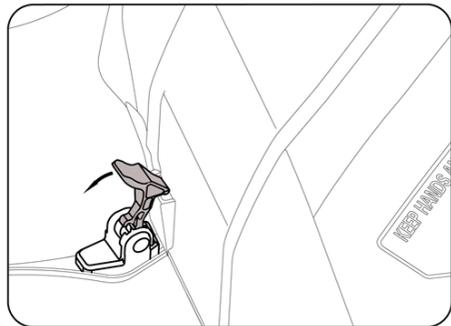
c. Coloque el gancho izquierdo en la ranura de la base de las piezas de autolock (Figura A) y el gancho derecho en el agujero de la plataforma (Figura D).
