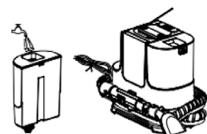
8. Después de la limpieza, instale la silicona en la tubería del cuerpo de la máquina alrededor de la máquina, y luego sujete el cuerpo del mango al gancho para una fácil organización.
