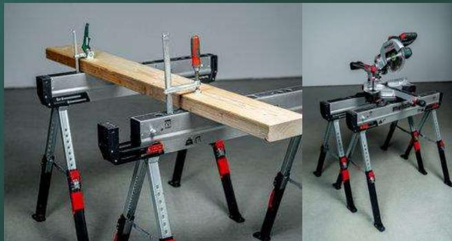
**2** Apoye su trabajo: Aberturas para abrazaderas y para fijar máquinas semiestacionarias
