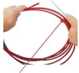
(4) Desenrosque el liner nuevo sin doblarlo
