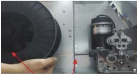
(12) Coloque la bobina de alambre de aluminio
