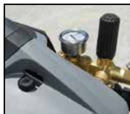
Sistema de revisión de aceite mediante varilla.
